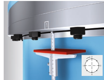
Bild 8: Prinzipieller Aufbau der Absenkmessung mit Tiefenmessschieber
