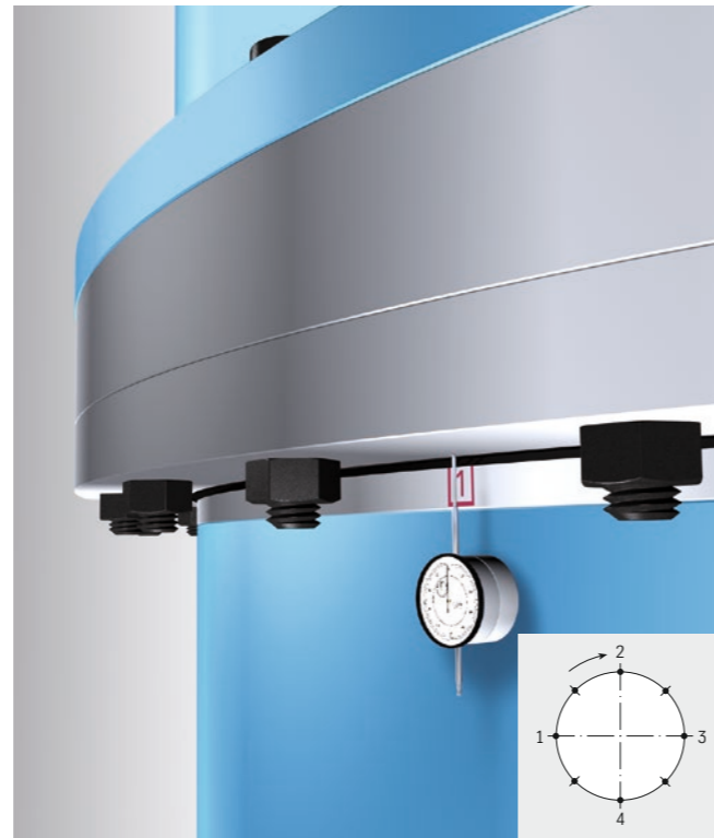
Bild 6: Prinzipieller Aufbau der Kippspielmessung
