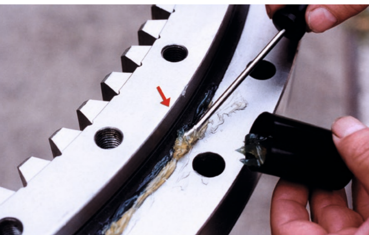
Bild 17: Fettentnahme an der Dichtlippe
